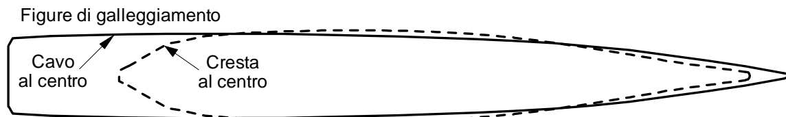
Fig. 6. Variación de la figura de flotación consiguiente al paso de una ola, en condiciones isocarenicas, habiente \lambda = L_{pp} e s_w = 1/30 [11].
